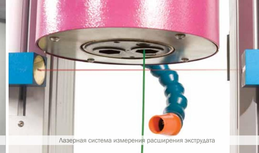
Лазерная система измерения расширения экструдата
